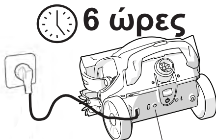
Ένδειξη μπαταρίας - Πλήρης φόρτιση (Σταθερό πράσινο)
